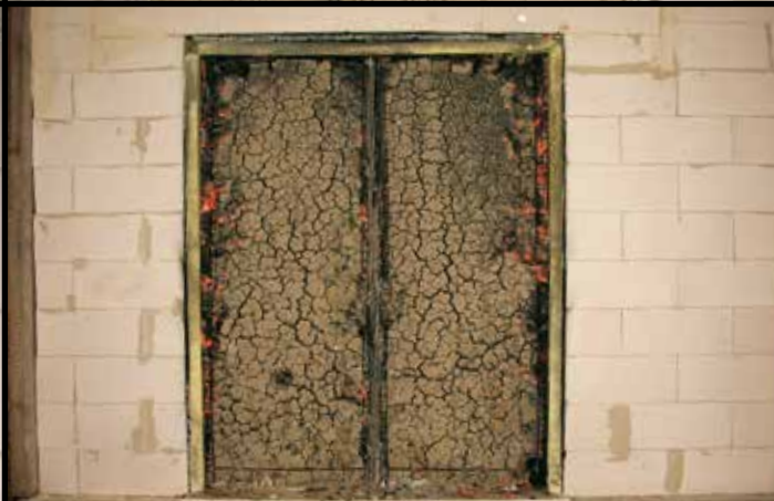
Na de proef; dit blijft er van de deuren over aan de brandzijde (in de oven)!
